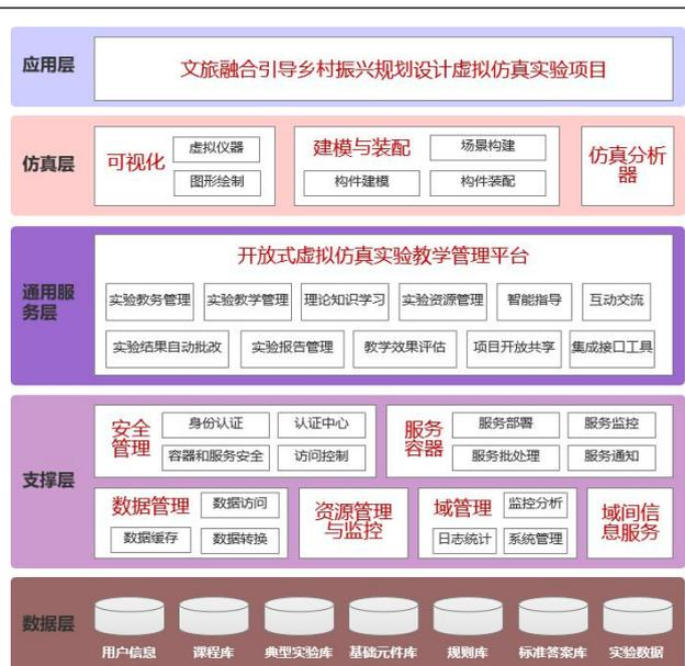
如图 1 所示，支撑项目运行的平台及项目运行的架构共分为五层，每一层都为其上层提供服务，直到完成具体虚拟实验教学环境的构建。下面将按照从下至上的顺序分别阐述各层的具体功能。
