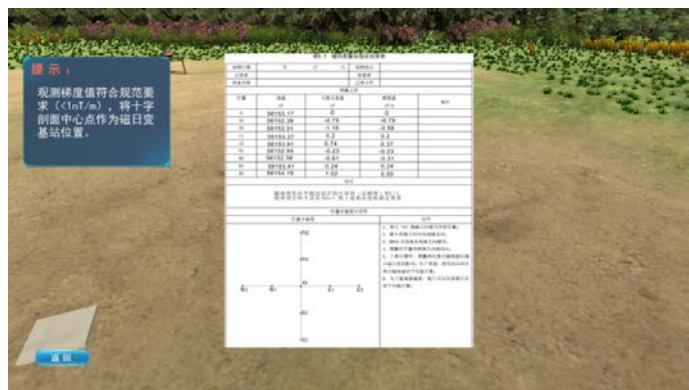
图 2-8-12 十字剖面测量结果
