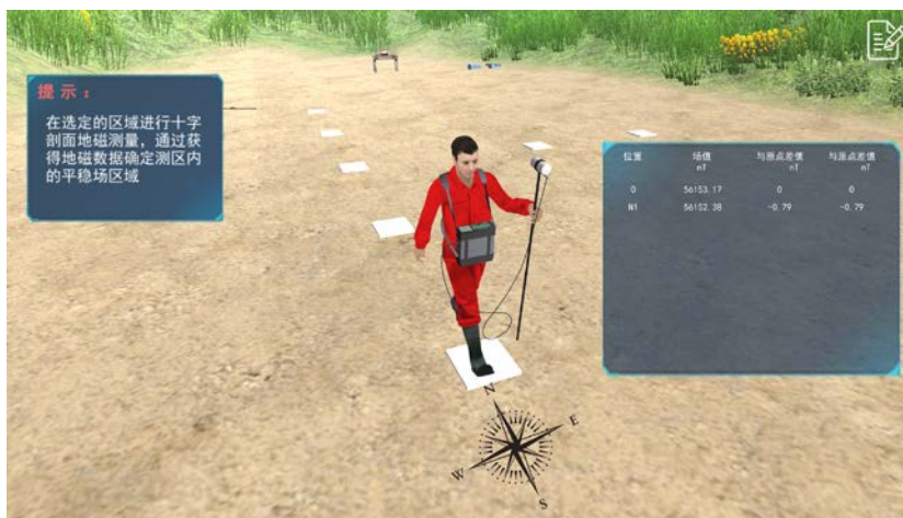
图 2-4-6 十字剖面测量法确定日变点位置
