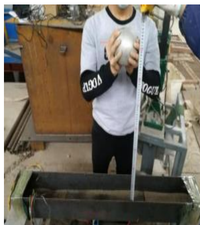
图 7-2-12 砂和工程碎屑物衬砌抗冲击性能研究装置
