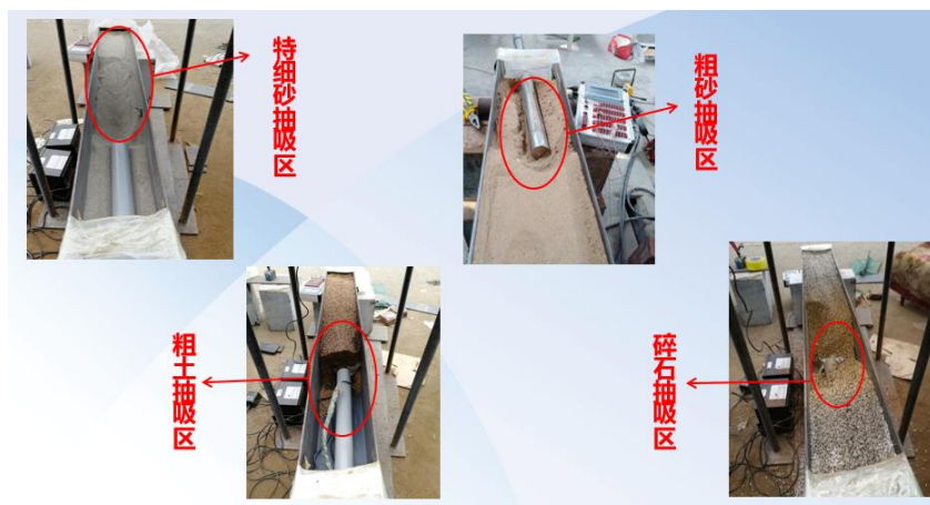
图 7-2-8 可抽吸砂和工程碎屑物衬砌支护技术试验过程
