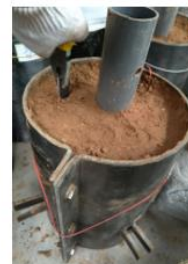
图2.8 土样中部布置压力传感器
