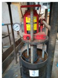
图2.5 组装置并在其内壁布置压力传感器
