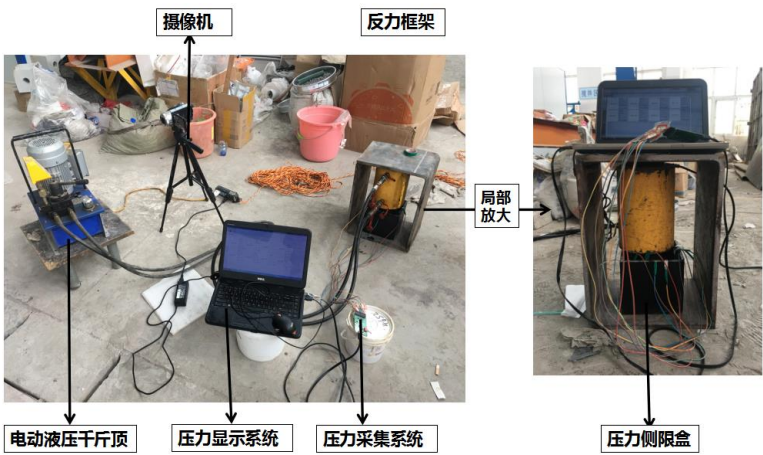
图 7-2-4 流质物压缩沉降试验图（砂、陶粒、土等）
