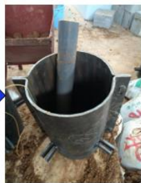
图2.5 组装置并在其内壁布置压力传感器
